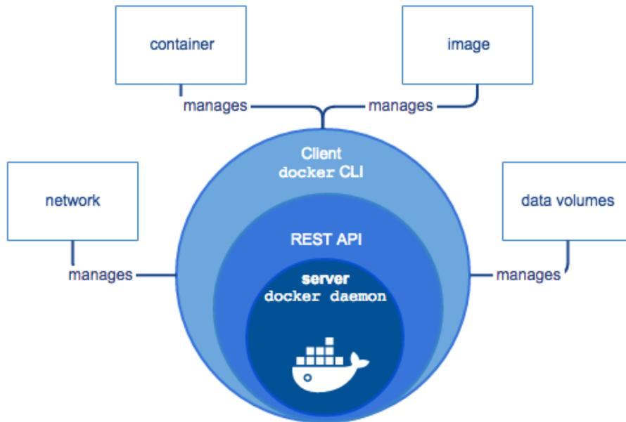
Figure 133: Docker Engine Component Flow [\[Image Source\]](#) [\[93\]](#)
